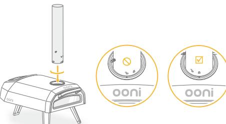
⑧ 本体の矢印と煙突の鍵開きマークを合わせて差し込み、煙突を鍵閉マークに回してセットしてください。
