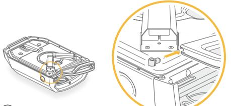
② ガラス製ピザオーブンドアの左側にヒンジピンを差し込みます。
