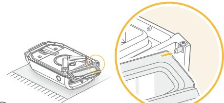
① 箱からピザオーブン本体を取り出し、傷がつかないよう柔らかい布などの上で上下逆さまに置き、ガラス製ピザオーブンドアを本体右側から差し込みます。
