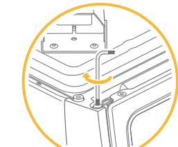
④ ドアプレートとピザオーブン本体をねじで2か所接続し、付属のトルクスキーでねじを締めます。
