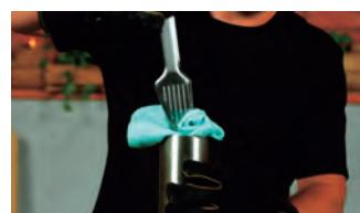
③煙突を外して、乾いた布をトングに挟み、煙突の内側を乾拭きしてください。
