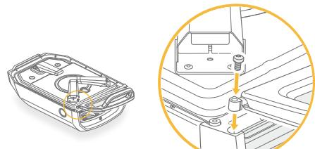
③ ②のヒンジピンとピザオーブン本体をねじで接続し、付属のトルクスキーでねじを締めます。
